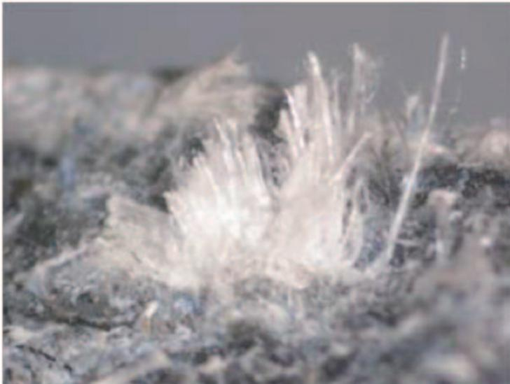
La amosita o amianto marrón pertenece al grupo de los anfíboles. Se trata de un silicato de hierro y magnesio, de color gris marrón; se caracteriza por sus fibras rectas y largas; es resistente a los ácidos y al calor. Su utilización principal se da como aislante térmico y en aplicaciones de alta fricción, como frenos y embragues para automóviles.
